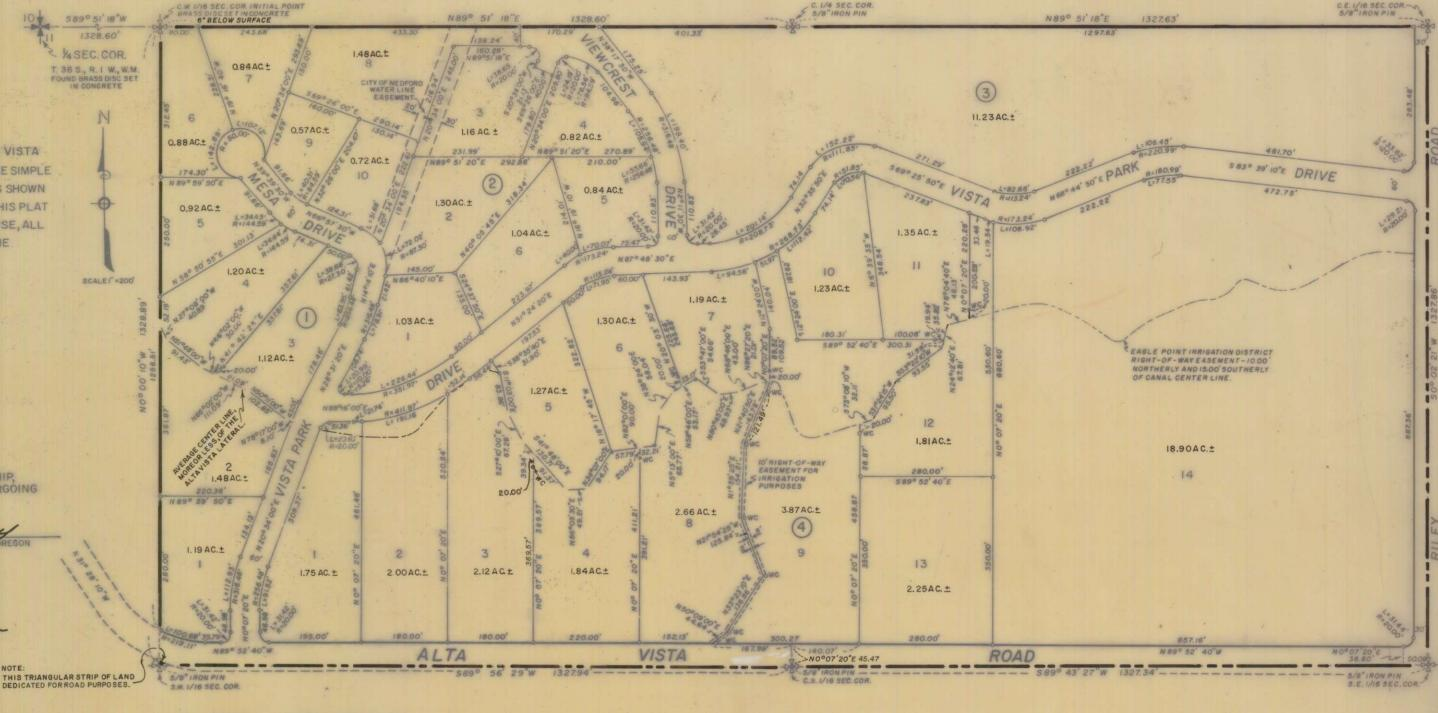
BEARINGS FROM RECORDED SURVEY NO. 1727 O=SET 5/8"X 30" IRON REINFORCING PINS ON ALL BLOCK CORNERS. SET 5/8"X 24" IRON REINFORCING PINS ON ALL LOT CORNERS, APPROXIMATELY FLUSH WITH GROUND SURFACE
