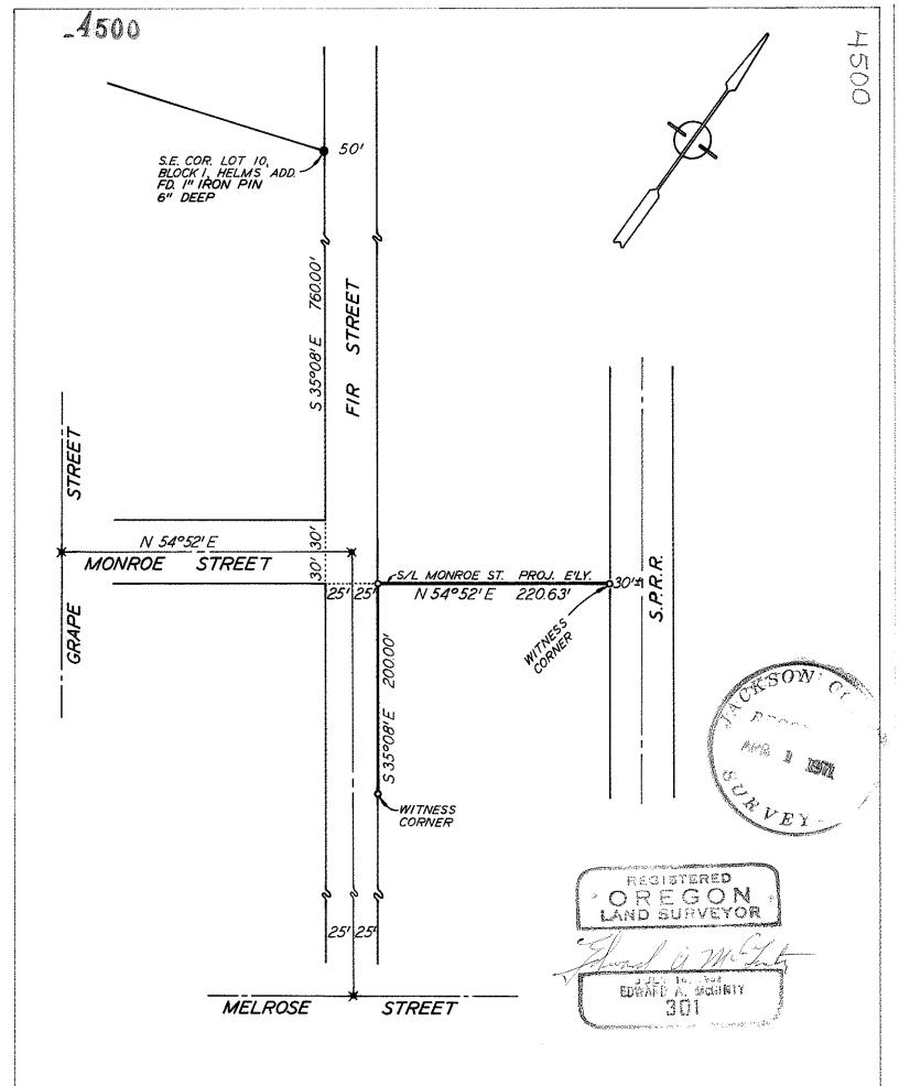
SURVEY IN S.W. 1/4 SEC. 30, T.37S., R. I W., W.M., J. CO., ORE.
